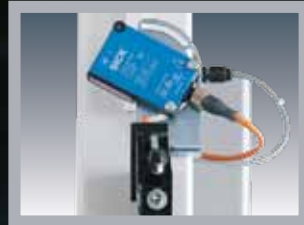
Sendereinheit für diagonale Korpus-Längenvermessung.
