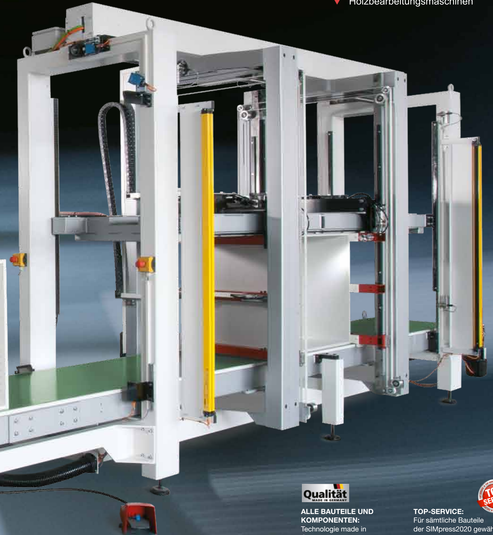
Seitliche Anschläge: Positionierung über Drehstrommotor mit Zahnriemen. Bremsung des mittleren Druckbalkens über Luftzylinder.
