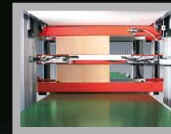
Seitliche Anschläge: Positionierung über Drehstrommotor mit Zahnriemen. Bremsung des mittleren Druckbalkens über Luftzylinder.
