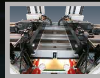
Vertikaler Druck über synchron gesteuerte Servomotoren.
