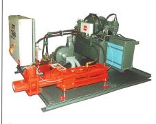
Eine Brikettieranlage vom Typ SHB 250 wurde für diesen Bedarfsfall auf einen Transportrahmen anschlußfertig montiert.
