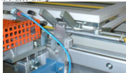
Beschlags-Längenerfassung am fahrbaren Schraubaggregat mit drei Klappanschlägen für unterschiedliche Längen der Eckumlenkungen.
