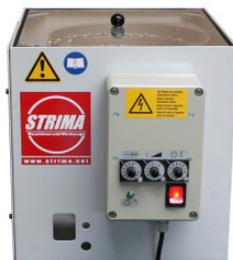
Automatisches Schraubenzuführgerät UHS 23 zur Zuführung der Schrauben an das Hochleistungs- Schraubaggregat mit Schraubspindel PVS 81.
