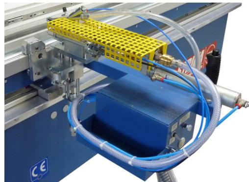
Hochleistungs- Schraubaggregat mit Schraubspindel PVS 81 und automatischem Schraubenzuführgerät UHS 23 mit Mehrfach-Höhenverstellung. Präzise Schraubung durch Tiefenabschaltung.
