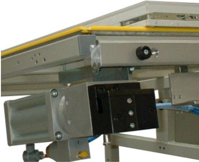
Beschlagstange zum Ablängen der Beschlagteile. Alternativ kann auch eine pneumatische Beschlagschere montiert werden.
