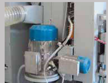
2) Posizionamento elettronico 2° albero principale (optional disponibile solo su Twin e Master). Permette l'utilizzo di utensili con diversi diametri di programmazione.
