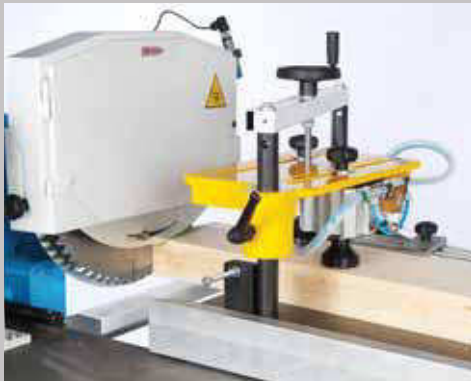
Fase di troncatura (laser opzionale)
