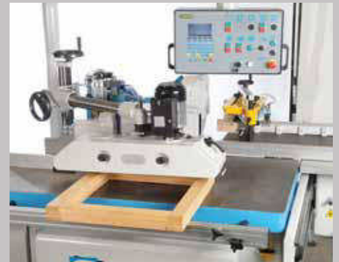
Spattentatura esterna delle ante
