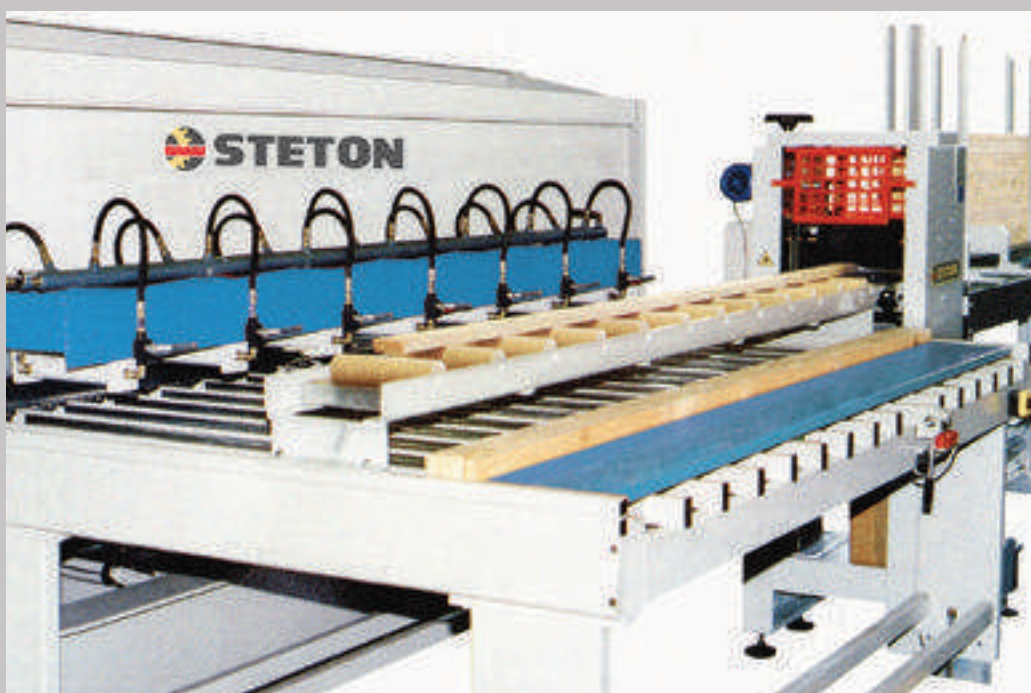
P 111 con incollatrice a rulli orizzontali, con alimentatore a tramoggia e via a dischi immersi
