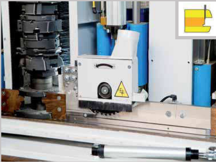
Gruppo standard listello fermavetro Standard glazing bead unit
