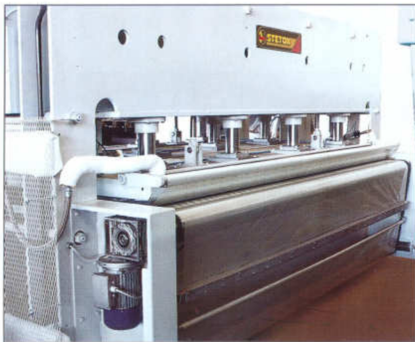
Sistema di trasazione con tappeto in "Mylar" Feeding system with "Mylar" belt
