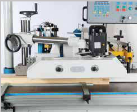
Profilatura interna degli elementi della finestra
