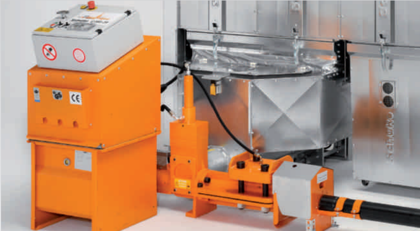
VACOMAT 200xp mit Spänebehälter SPB50 und Compacto Brikettierpresse
