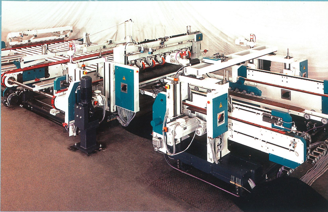
Besäumung und Aufteilung von Einzelplatten
