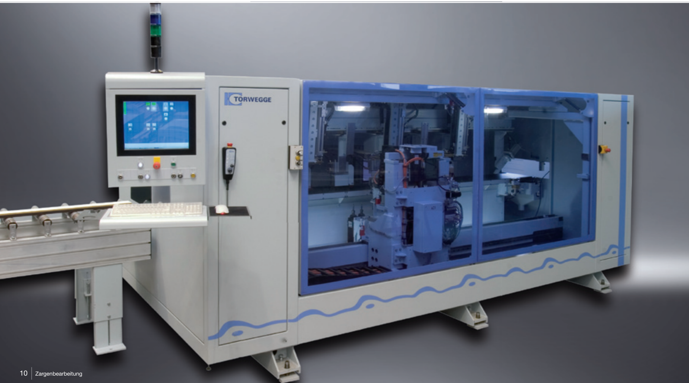
Zargenbearbeitungsmaschine in Ausführung der ZKR für kombinierte Bearbeitung von Schließblech und Band
