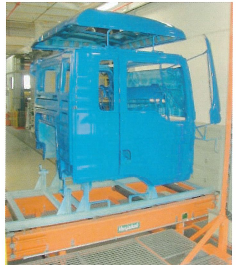
Skidförderer zum Transport von LKW-Führerhäusern durch Lackieranlage und Trocknung.
