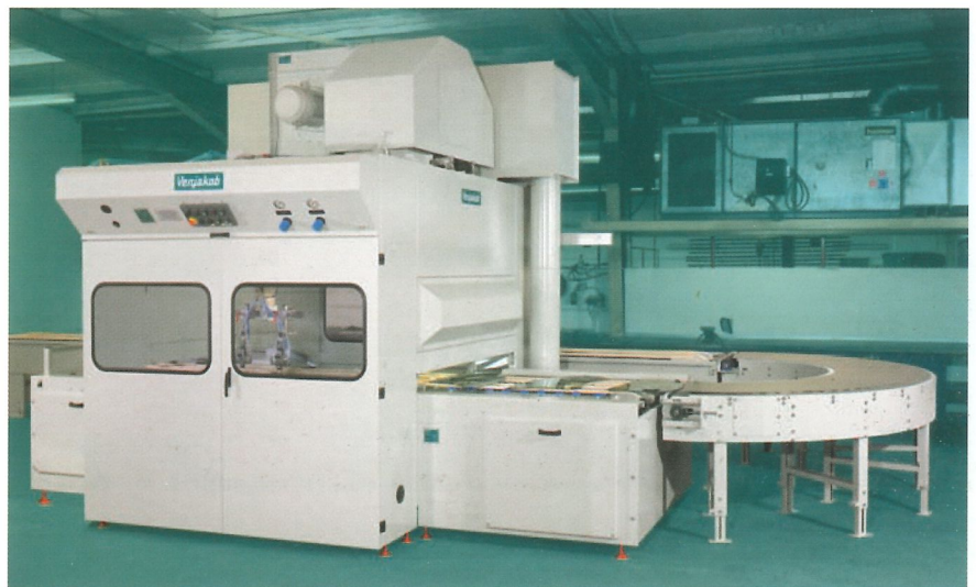
Glasbeschichtungsanlage: Hydrophobisierung von Autoscheiben.
