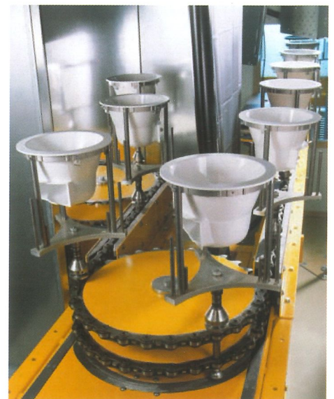
Spindelkettenförderer zum kontinuierlichen bzw. taktenden Transport mit rotierenden Spindeln.
