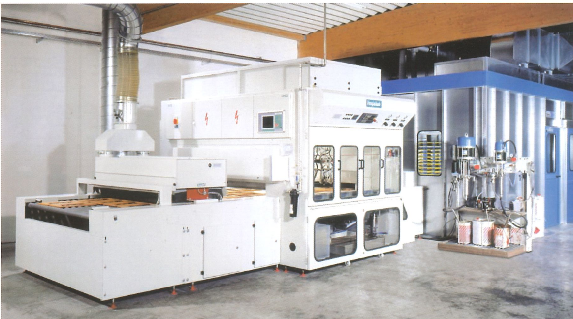
Flächenlackieranlage mit angeschlossener Reinraumkabine.
