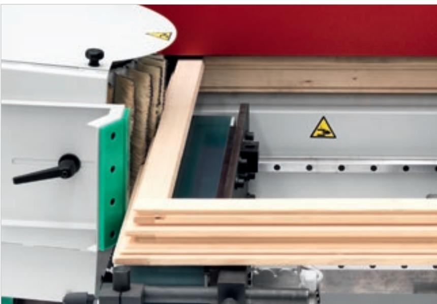
Die **Gruppe mit vertikalen Bürsten Win** ist ein Feinschleifsystem mit senkrechten rotierenden Bürsten. Mit dieser Einheit können die Profile und die seitlichen Flächen des Werkstücks durch Bürsten feingeschliffen werden, wodurch Glätte und Homogenität gewährleistet sind. Die einzelnen Gruppen, die mit Bürsten von großem Durchmesser (300 mm oder 400 mm) ausgestattet sind, können unabhängig voneinander in seitlicher Position, Neigung (-10° +35°) und Höhe eingestellt werden.
