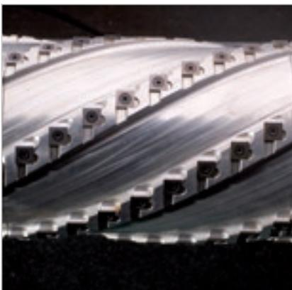
Mit dem **HPG-Aggregat**, das zum Kalibrieren von Sperrholzplatten empfohlen wird, können mehrere Millimeter in einem einzigen Durchgang abgetragen werden.
