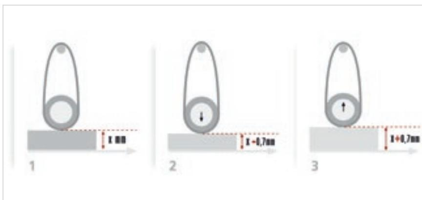
Die **Walzengruppe mit HP-Technologie (High Performance)** ermöglicht die Bearbeitung von Platten unterschiedlicher Dicke, ohne die Arbeitshöhe ändern zu müssen. Diese Lösung reduziert die Einstellungszeiten der Maschine und garantiert eine gleichmäßige Glättung, auch auf Plattenpartien mit Dickenunterschieden bis 1,4 mm.
