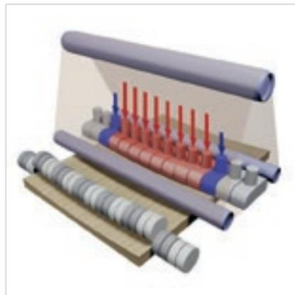
Das HP-System ist in Version **DUO** erhältlich, das die Modulation zweier Betriebskräfte für jeden einzelnen Bereich in jedem beliebigen Moment gewährt. Dank dieser Lösung erhält man unterschiedliche Betriebskräfte auf derselben Platte.
