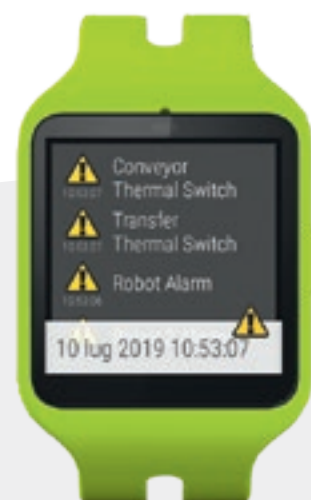
BENACHRICHTIGUNGEN Liste der Alarme oder Wartungsanforderungen. Jedes Mal, wenn die Maschine ein Problem oder eine Wartungsanforderung anzeigt, vibriert die Viet Watch und am Bildschirm erscheint ein Gefahrensymbol.
