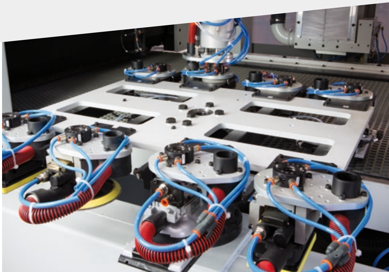
Estação porta-ferramentas com oito (8) posições para uma rápida troca automatizada de ferramentas em tempo mascarado.
