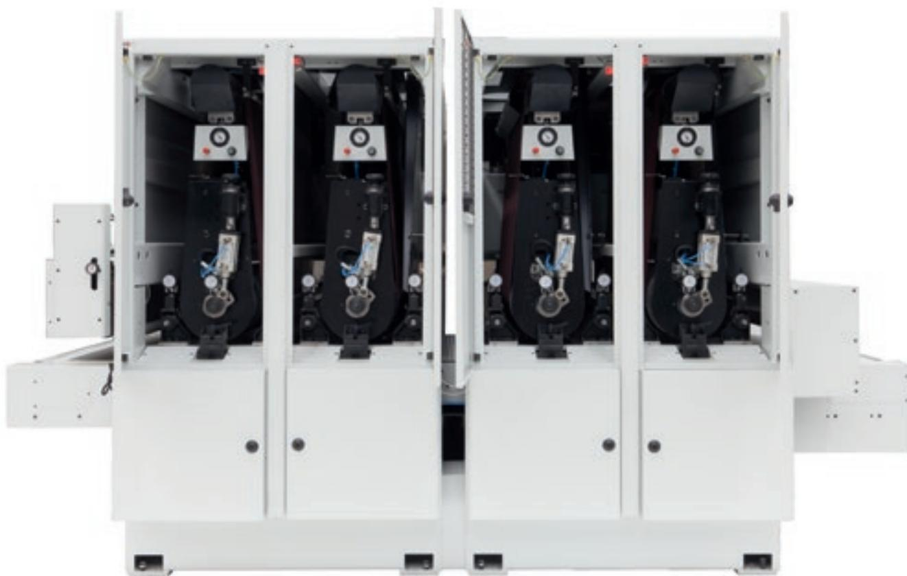
Valeria se puede configurar solo como calibradora, maximizando sus prestaciones; por ejemplo, en el modelo de 4 grupos se puede instalar una potencia total de 300 CV.
