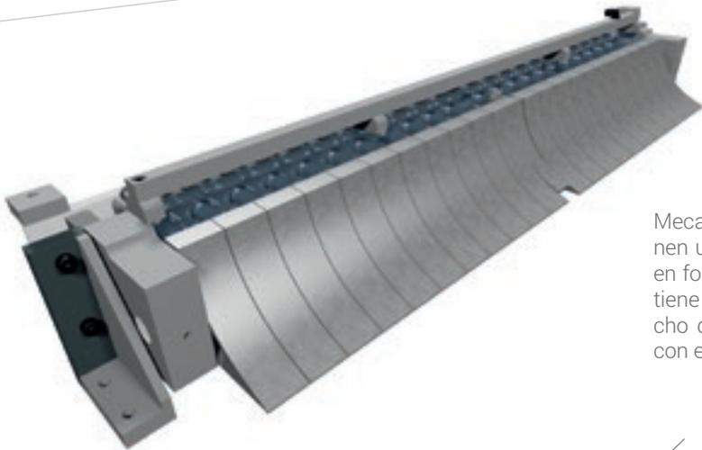
Mecanizado de máxima precisión, incluso con paneles que tienen una gran diferencia de espesor, gracias al presor partido en forma de pie situado a la entrada de la máquina que mantiene el panel en contacto con la cinta a lo largo de todo el ancho de mecanizado. Este componente siempre se combina con el grupo de cepilladora HPG.
