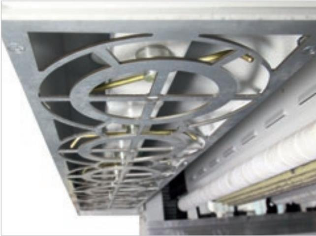
El **soplador orbital**, situado a la salida de la máquina, limpia perfectamente la superficie del panel al término del ciclo de lijado.
