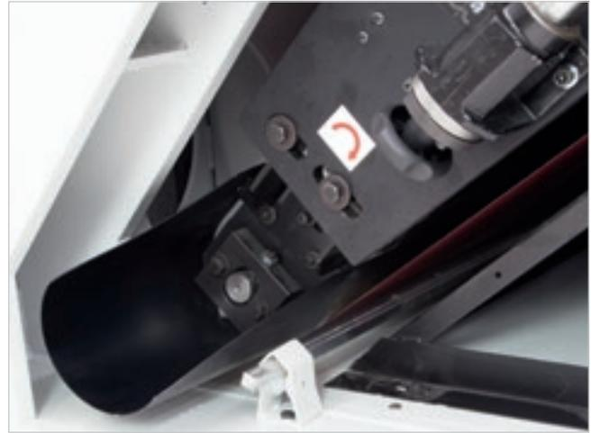
El **soplador lineal oscilante** impide que se atasque la cinta, manteniendo la condición de la superficie del abrasivo en condiciones excelentes a lo largo del tiempo. El componente optimiza el consumo de aire soplando y oscilando automáticamente, solo durante el mecanizado del panel.
