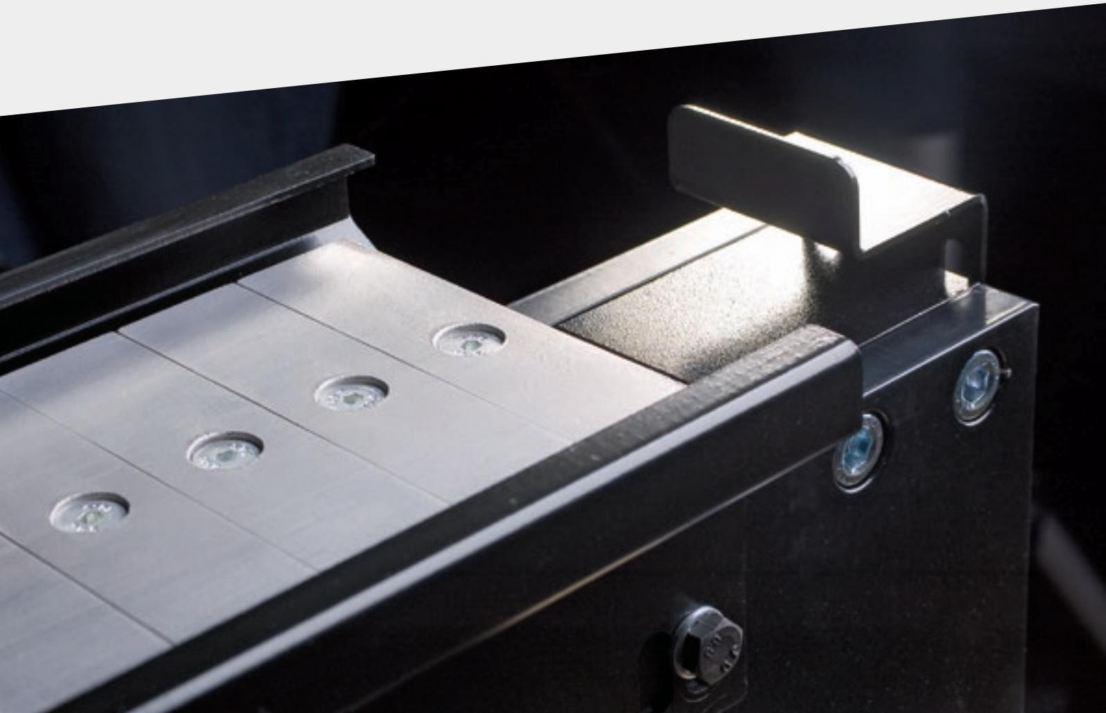
El **grupo de lijado mediante tampón** es la herramienta ideal para el lijado de acabado con poca rugosidad superficial. Se ofrece con tampón neumático o electrónico. El **tampón electrónico** seccionado permite alisados de alto nivel de calidad gracias a los sectores electroneumáticos accionados solo en la superficie del panel. Las numerosas regulaciones posibles ofrecen funciones específicas para todos los tipos de mecanizado.
