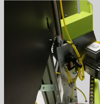
DISCO de corte para Mecanizar el otro extremo del inglete del cabecero
