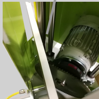
DISCO de corte para Mecanizar un extremo el inglete del cabecero
