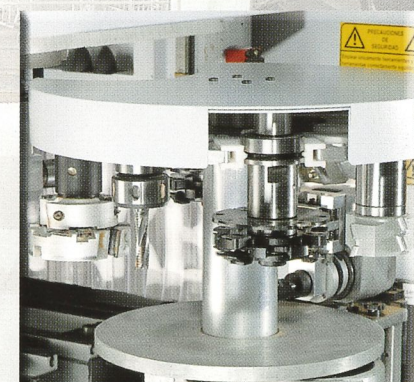
Mitfahrender 8fach Werkzeugwechsler in X-Richtung
