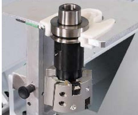
Sicheres und schnelles Beschicken des Werkzeugwechselfmagazines
