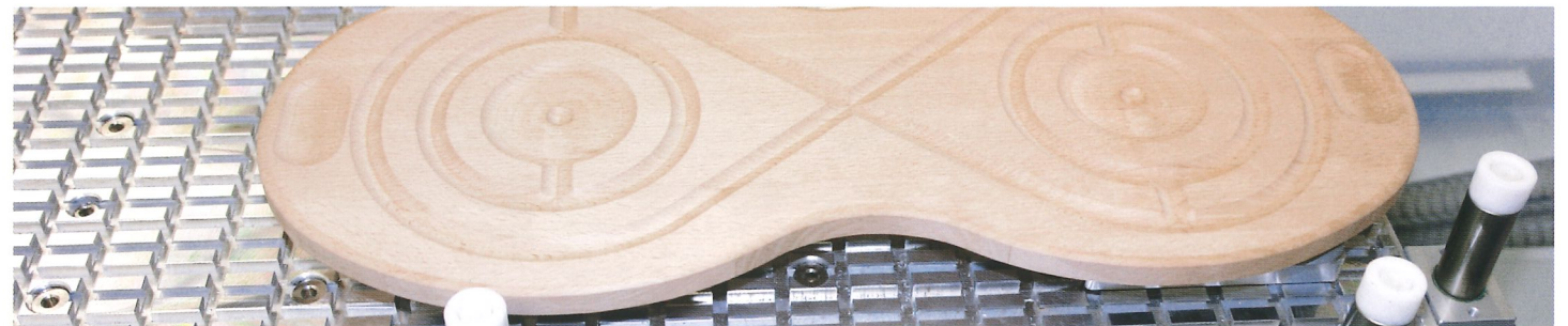
Der Aluminium-Rastertisch ist für verschiedenste Anwendungen und Materialien einsetzbar
