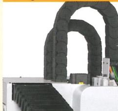
Sichere und geschützte Kabelführung (X-Y-Z)
