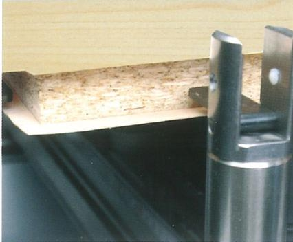
Gewährleistet einfaches Positionieren bei Material mit Furnierüberstand
