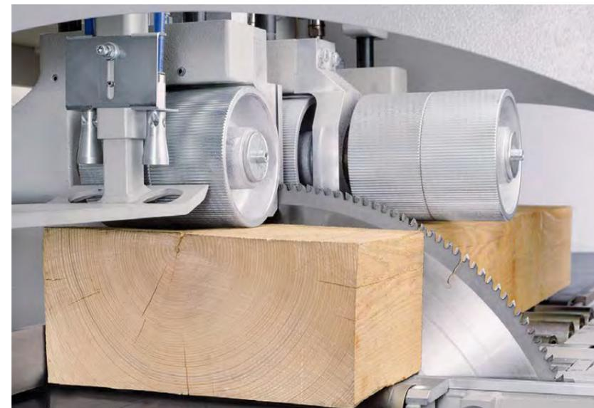
**Die OptiCut 450 XL** ist mit extra breiten Vorschubrollen ausgestattet, die mehr Drehmoment auf schwere Holzquerschnitte bringen. Trotz der großen Querschnitte sind eine überraschend hohe Schnittleistung und Längengenauigkeit möglich. Je nach Querschnitt kann zwischen Vorschubgeschwindigkeiten von 120m/min und 180m/min umgeschaltet werden. Selbstverständlich stehen für die OptiCut 450 XL die passenden Beschick-, Markier- und Sortierlösungen zur Verfügung – speziell auch für schweres Holz.
