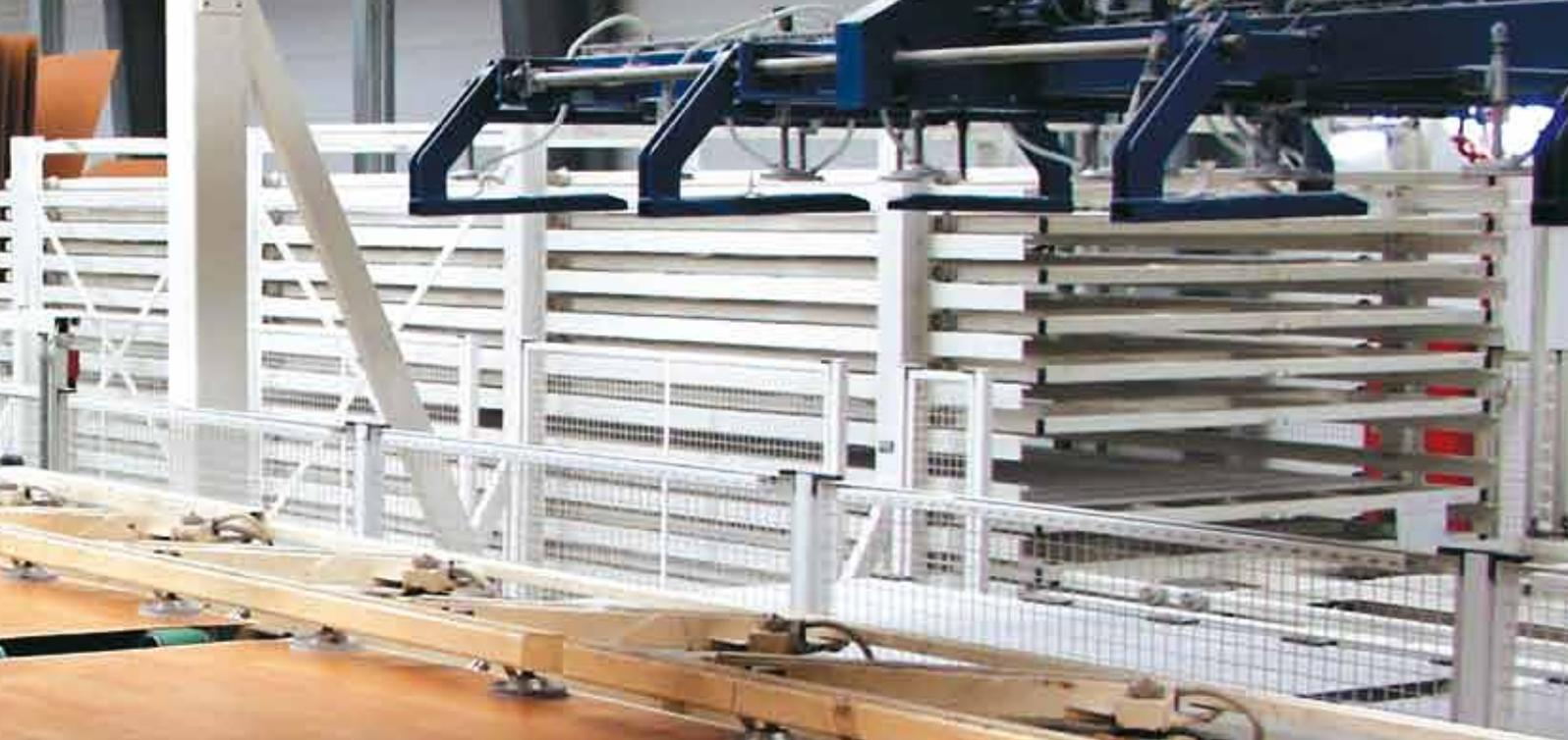
ohne Taktzeitverlust, Filmlegestationen mit Einzelblattausrichtung, Abstapelanlagen mit Schonerplattenhandling, Doppelkühl- und Pressblech-Wechselstationen stehen nur beispielhaft für den Einsatz von Komponenten, die eine größtmögliche Flexibilität und einen reibungslosen Ablauf vor und nach dem eigentlichen Pressvorgang garantieren. Selbstverständlich kann eine Wemhöner Kurztaktpressen-Anlage auch als integrationsfähige Einzelanlage konzipiert und geliefert werden.
