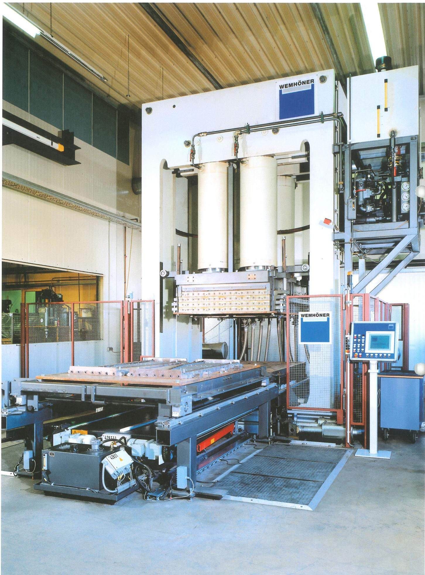
Spezialpresse für die Vulkanisieretechnik mit einem spezifischen Druck bis zu  $800 \text{ N/m}^2$ , maximale Temperaturen bis  $250 \text{ }^\circ\text{C}$
