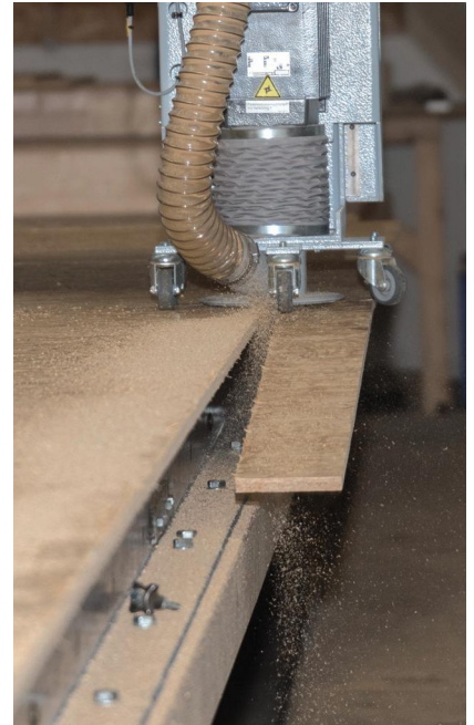
Formatowanie powierzchni zewnętrznych
