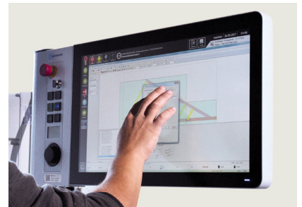
Opcja: szybkie wprowadzanie danych bezpośrednio do maszyny za pomocą easyRUN
