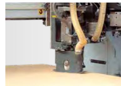
**WALLTEQ M-300: Vollautomatisches Bearbeiten mit Sägeaggregat**
