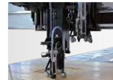
**Aufnahme für zweites Befestigungsaggregat**
