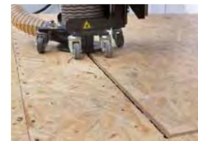
**WALLTEQ M-320: Vollautomatisches Bearbeiten mit Fräsaggregat**
