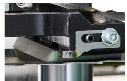
Guida in carbonio "high-tech" estremamente resistente all'abrasione
