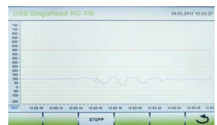
Monitoraggio della sega guidato da sensori
