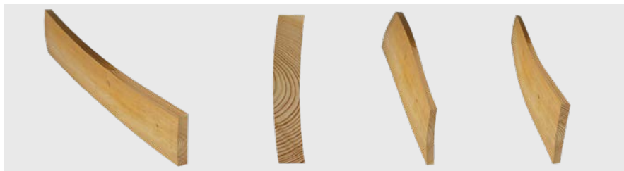
Заготовки с искривлениями в продольном и поперечном направлениях, углублениями и перекосами
