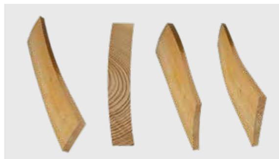
Blocs avec voilement longitudinal ou transversal, bombage ou gauchissement
