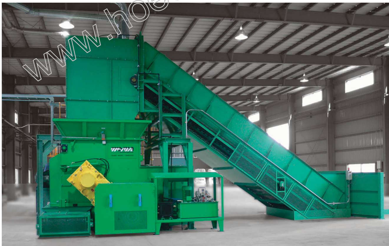
WLK 25 Super-Jumbo mit elektromechanischem Antrieb, Lee (Korea) WLK 25 Super-Jumbo with electromechanical drive, Lee (Korea)
