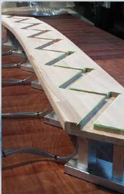
Vorab-Anzeige der Ausfräsung für die Trittstufen auf einer Treppenwange. Sauger können ebenfalls mit Hilfe des Laserprojektors ausgerichtet werden.
