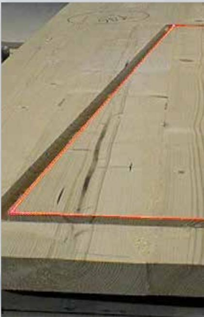
Bei der oben abgebildeten Treppenstufe zeigt der Laser die Kontur der Ausfräsung an. Die Stufe wurde unter Berücksichtigung der Holzmaserung optimal an der Kante des Werkstoffes ausgerichtet, was den Verschnitt reduziert.
