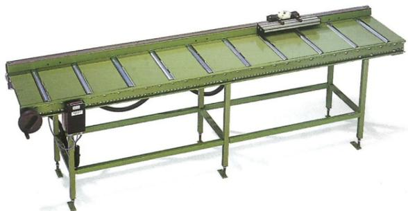
Während die Basisausführung 'EXAKT-C' alleine der Werkstückzufuhr dient, sind die Modelle 'EXAKT-A' und 'EXAKT-B' mit elektromagnetischen oder manuellen Längenmeßsystemen ausgestattet.
