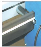
Die Rollenbahn EXAKT A kann auch mit einem direkten Magnetbandmesssystem geliefert werden. Der Antrieb des Anschlagwagens und die Längenmaßabnahme sind dadurch voneinander unab-Die Maßanzeige erfolgt
