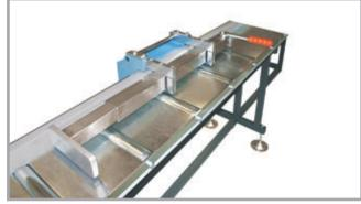
Der Materialanschlagarm ist gefedert und einstellbar bis zum 0-Punkt. Er ist manuell nach hinten wegklappbar mit einem Exzenterhebel zur Freistellung. Art.Nr. SZ 05 \*
