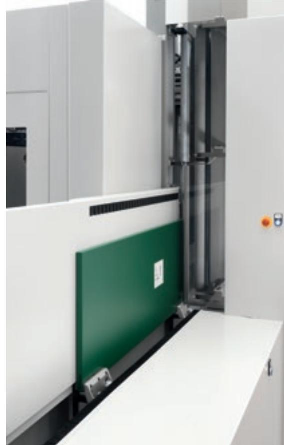
Zudem sind die **Zangen** mit einem System zum Vermessen der Dicke der Platte ausgestattet, wodurch sich der Wert des Programms in Echtzeit ändern lässt. Damit ist die Präzision für die auf die Achse „Z“ bezogenen Bearbeitungen gewährleistet.
