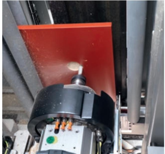
Pantographfräsmaschine mit integrierter C-Achse (Option).
