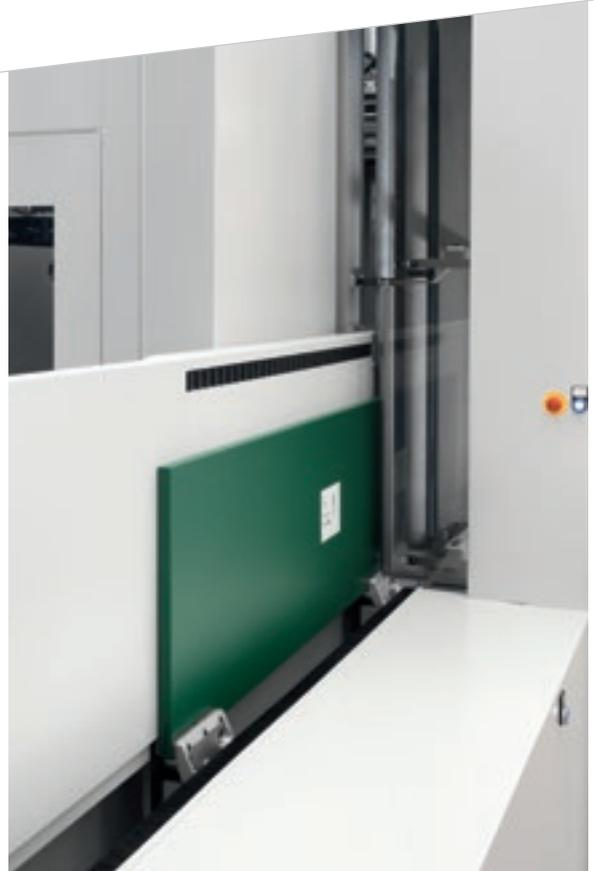
Le **pinze** sono inoltre dotate di un sistema di rilevazione dello spessore del pannello che permette di modificare in real time il valore del programma garantendo la precisione delle lavorazioni riferite all'asse "Z".
