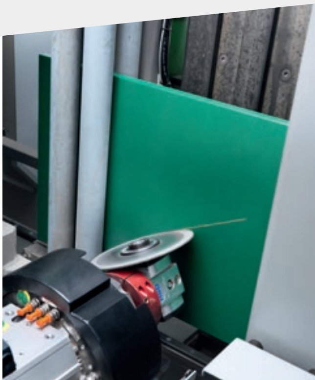
Défonceuse avec axe C intégré (optionnel).
