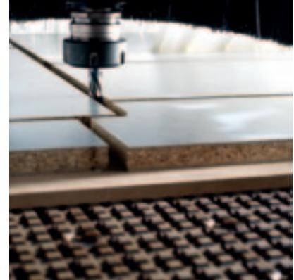
Für die Nesting-Bearbeitung hat die Biesse Wood Division Bearbeitungszentren mit Raster-tisch entwickelt. Je nach Art der Bearbeitung können Sie wählen: vom Einstiegsmodell über die besser ausgestatteten Rover-Modelle bis hin zu den Excel-Oberfräsen wählen.
