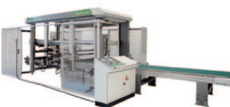
Biesse offre soluzioni dedicate alla progettazione e produzione di avvolgitori automatici, come Cinetic e Orbiter, per proteggere e stabilizzare carichi palletizzati con film estensibile. Completa la gamma delle imballatrici Star Space Saver con rulli intercambiabili e forno per il termoretraibile.
