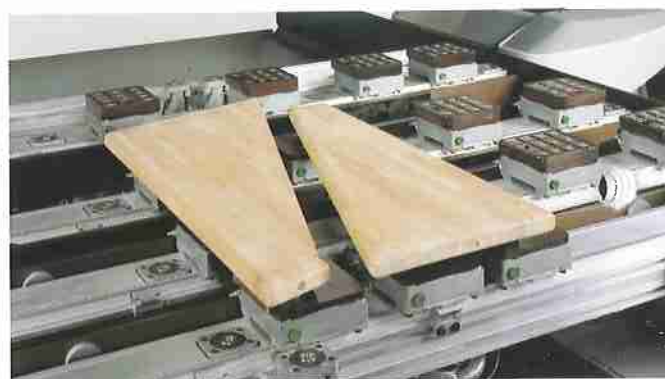
Lavorazione del gradino Bearbeitung der Stufe
