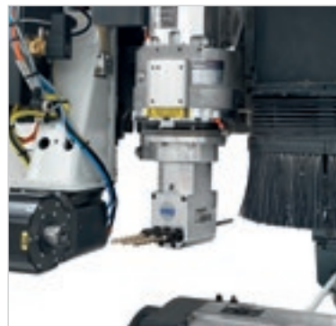
Il gruppo multifunzione posizionabile in continuo su 360° da CN, può ospitare aggregati per l'esecuzione di lavorazioni specifiche (incasso per serratura, sedi per cerniere, foratura orizzontale profonda, intestatura, ecc.).
