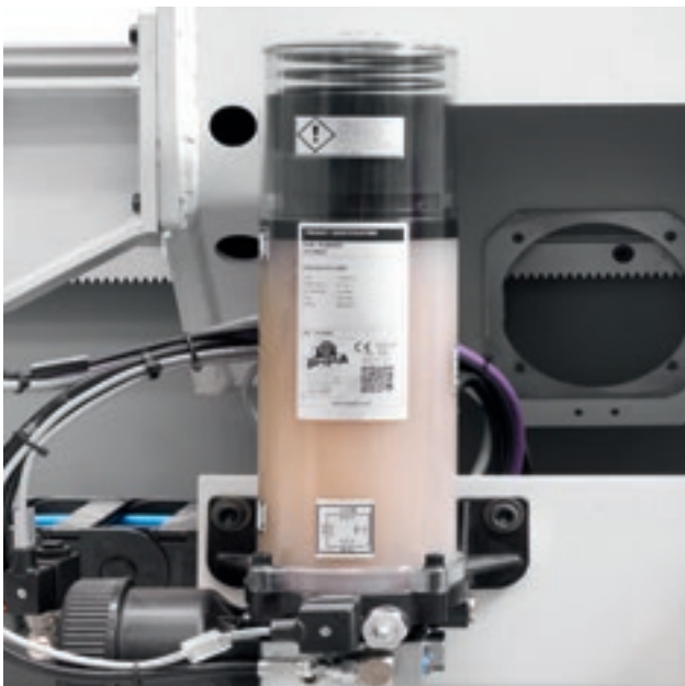
Lubrification automatique tête de perçage BH29 2L.
