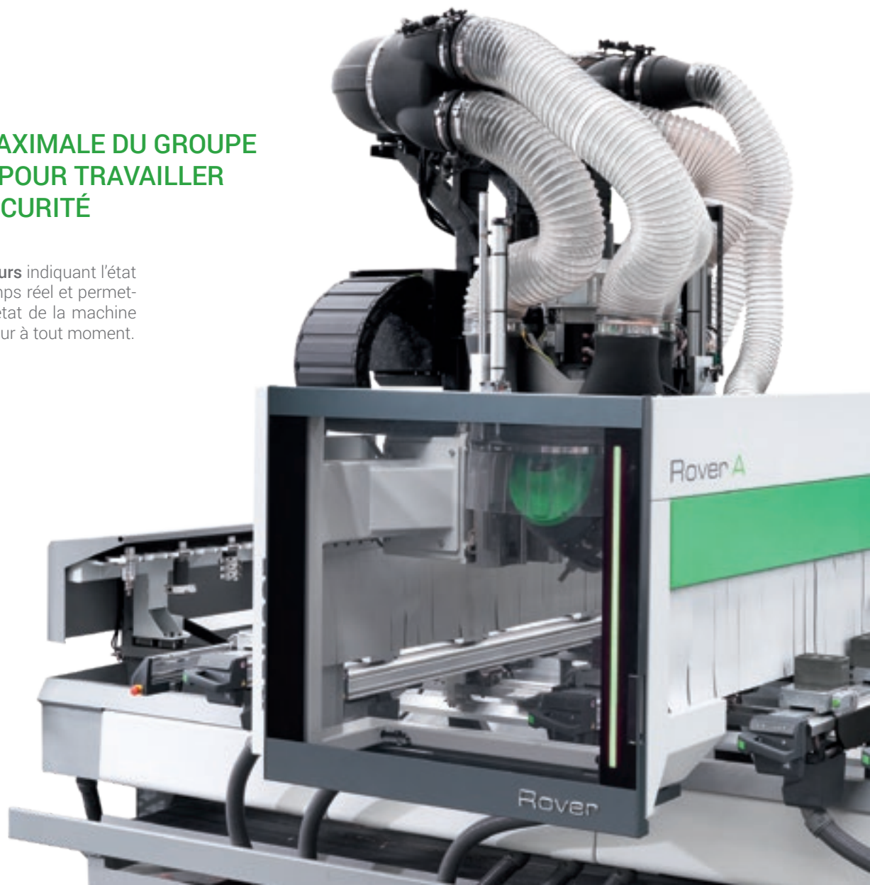
Bandes latérales pour protéger le groupe opérateur, mobiles pour travailler à la vitesse maximale en toute sécurité.
