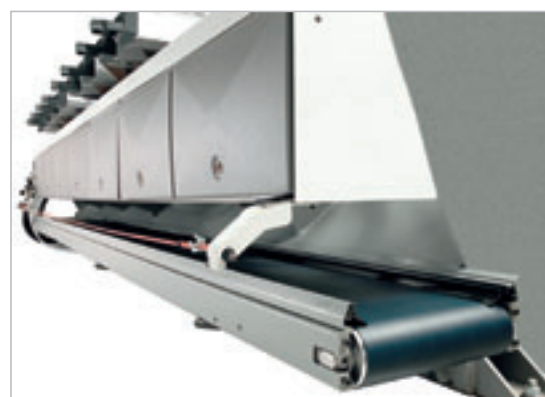
Tappeti motorizzati per la rimozione di trucioli e sfridi.
