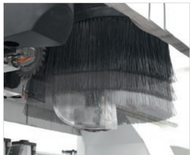
Campana de aspiración regulable en 6 posiciones (para 4 ejes) y 13 posiciones (para 5 ejes).
