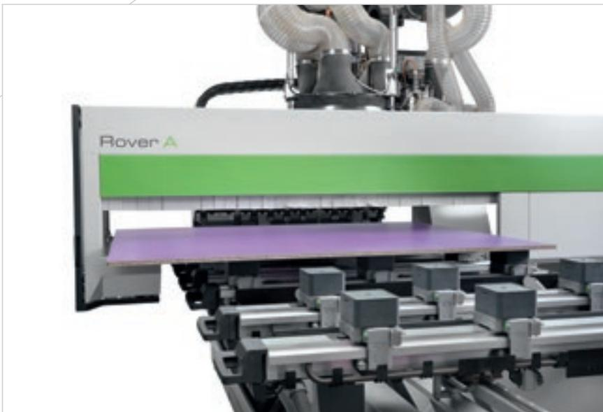
La possibilité de charger des panneaux de 1900 mm de profondeur permet d'éviter la phase de pré-coupe et d'exécuter des façonnages de pièces plus grandes que la zone de façonnage en double positionnement.
