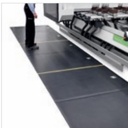
Les **tapis de détection sensibles** permettent à la machine d'usiner à vitesse maximale constante.
