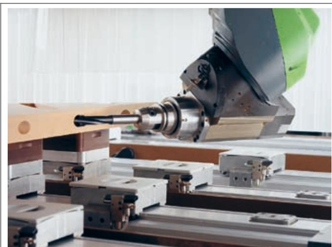
□ 3: Der schlanke Motorenkörper des 5-Achs-Kopfs ermöglicht extrem kleine Winkel bei der Bearbeitung von Staketenbohrungen
