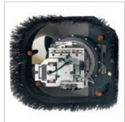
Gruppo soffiante a 4 uscite utilizzabile anche con gli aggregati di finitura del bordo.
