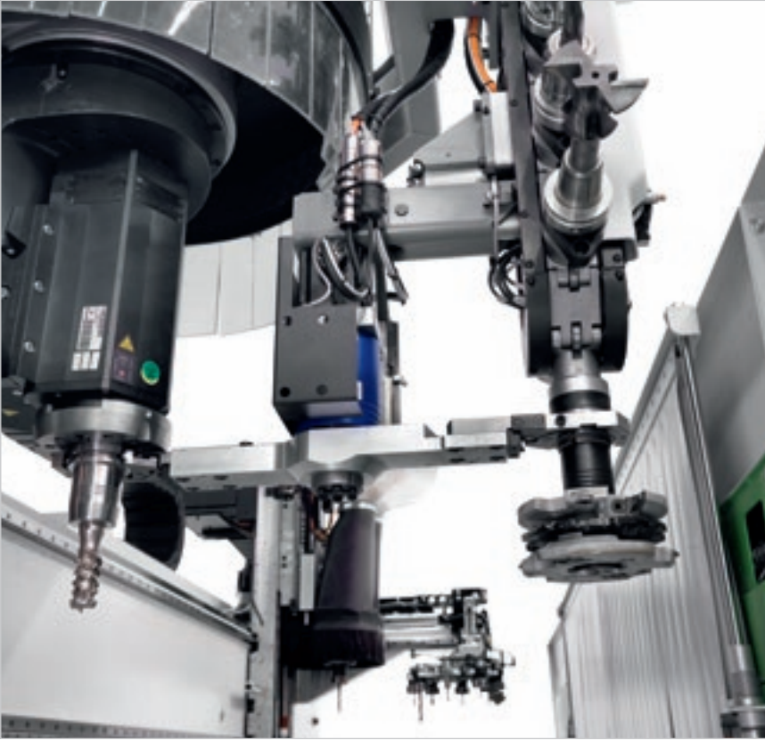
Magazzino utensili a catena verticale su asse Y da 10-15 posizioni.
