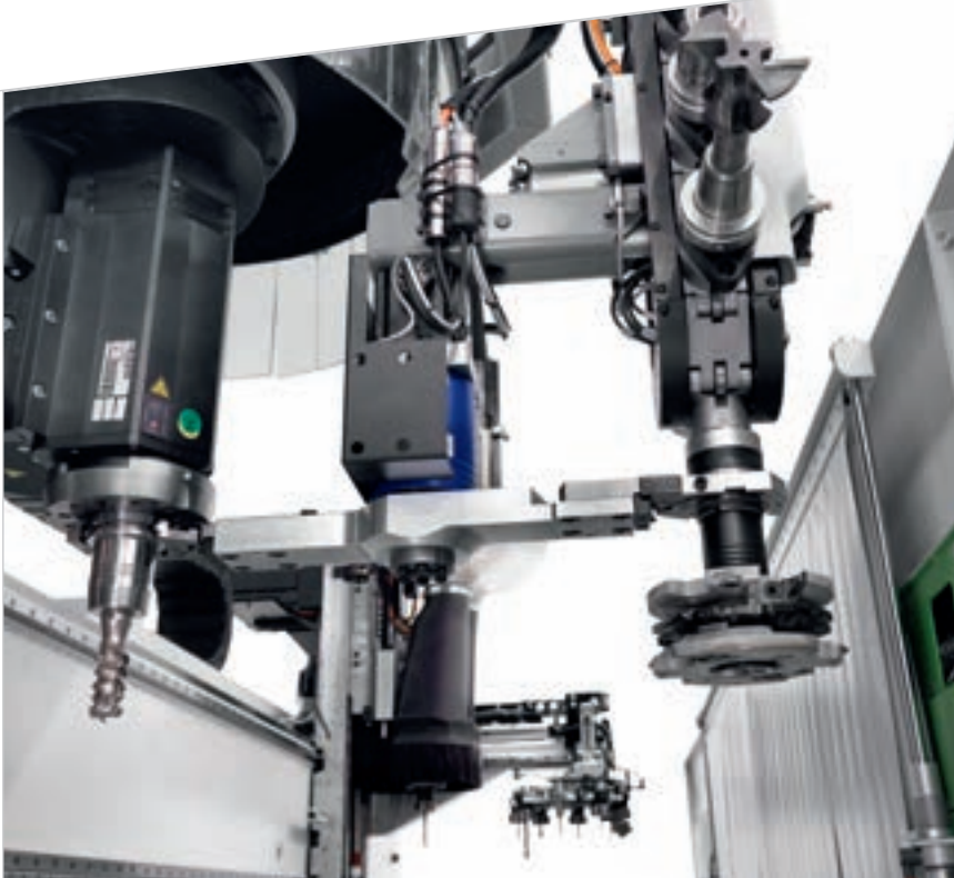
Магазин инструментов в виде вертикальной цепи на оси Y на 10-15 позиций.
