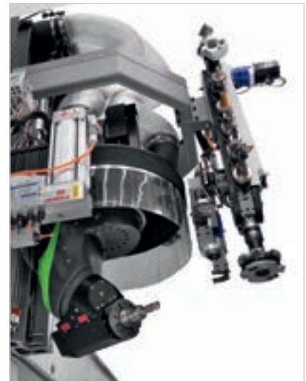
Магазин инструментов в виде вертикальной цепи на оси Y на 10-15 позиций.
