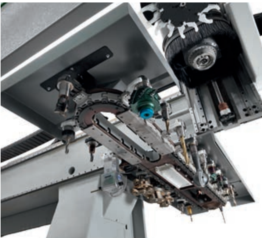
Простая и быстрая замена сверл благодаря эксклюзивной системе быстрого крепления шпинделей.
