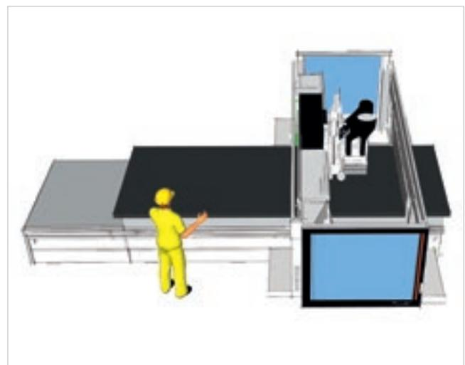
E' possibile configurare la macchina con la funzionalità pendolare per poter lavorare pannelli sulle origini opposte in maniera alternata ed effettuare quindi le operazioni di carico e scarico in tempo mascherato.
