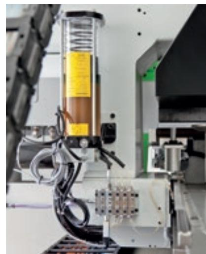
La **lubrificazione automatica** è un'opzione che garantisce una continua lubrificazione dei principali organi di movimentazione della macchina senza richiedere l'intervento dell'operatore.
