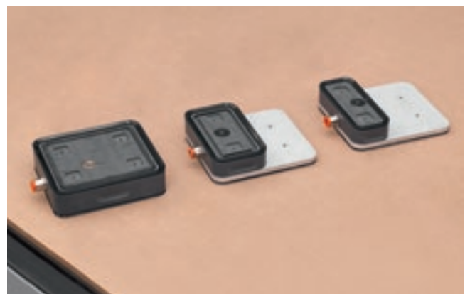
Vakuum-Module direkt auf der Grundplatte positionierbar. Die Module können einfach und schnell ohne Hilfsvakuumanlage verwendet werden.
