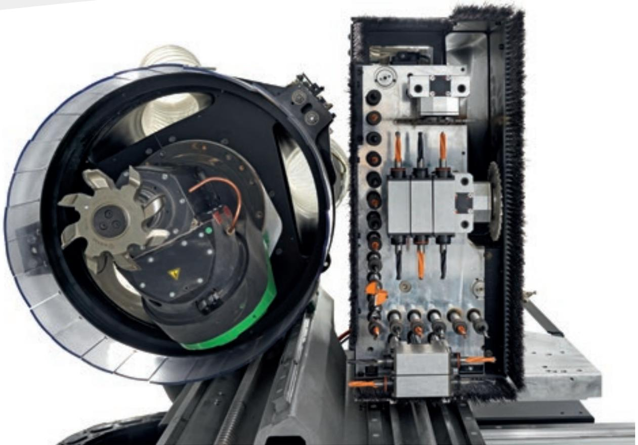
La nuova testa a forare BHZ 29 2L, è dotata di lubrificazione automatica e raffreddamento a liquido per garantire la massima precisione.
