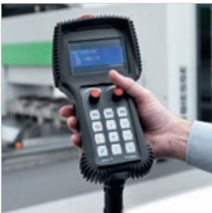
**Console remota** per un controllo diretto e immediato da parte dell'operatore.
