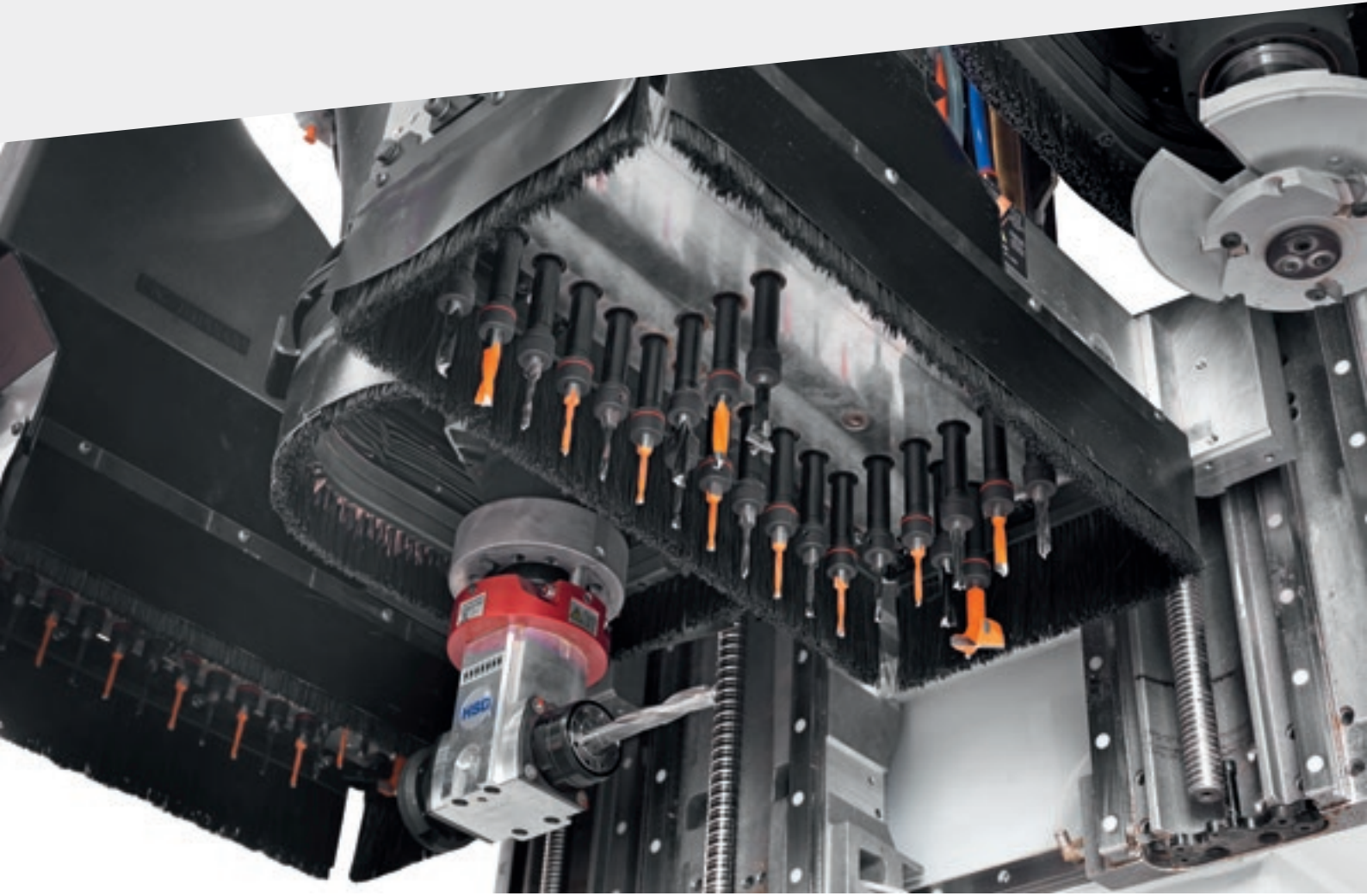
Testa a forare BHZ 22 per la massima capacità in foratura nesting in configurazione doppie, massima produttività nella sua categoria.
