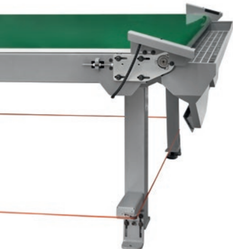
Sistema di aspirazione trucioli disposto tra la macchina e il tappeto di scarico, garantisce la massima pulizia dei pezzi.
