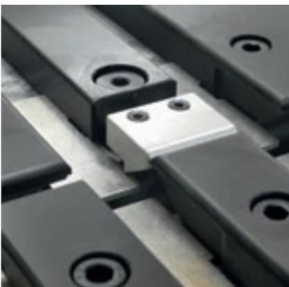
Sistema de cierre de la línea de corte para evitar la caída de recortes longitudinales.
