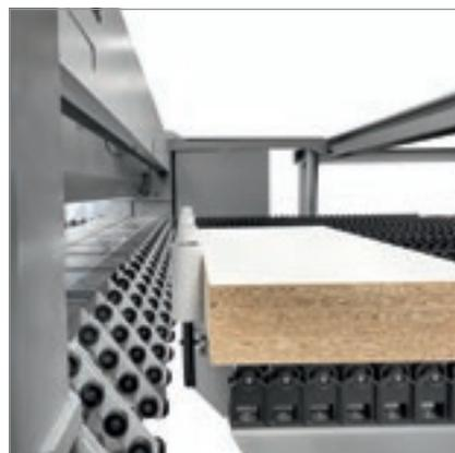
Los recortes longitudinales se evacúan a través de una trampilla completamente automática compuesta por ruedas libres.
