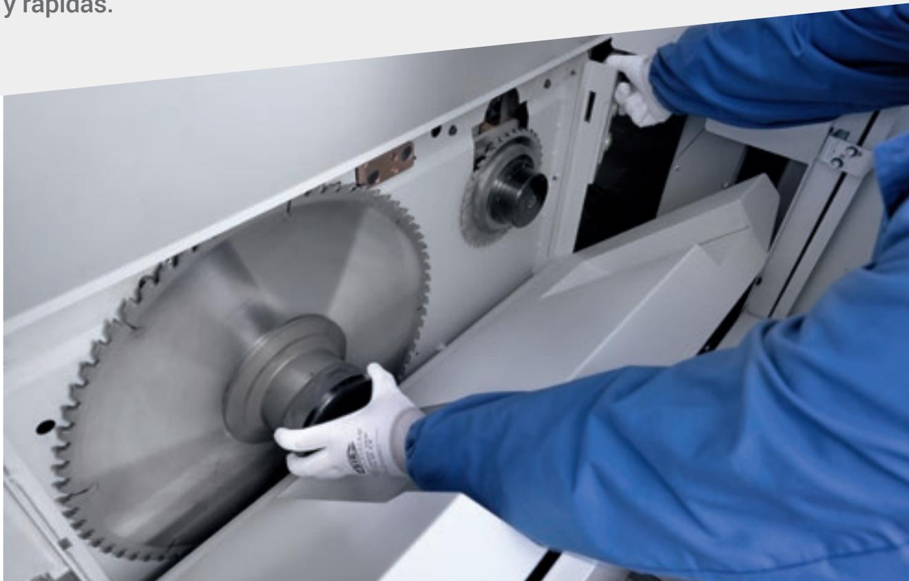
El sistema **"Quick change"** es el dispositivo más rápido, ergonómico y seguro para sustituir las hojas sin usar herramientas.
