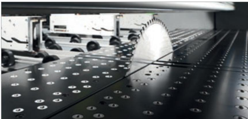
Superficie del cuerpo de la máquina con colchón de aire para el desplazamiento de materiales delicados. Esta característica permite además mantener constantemente limpia la superficie situada justo al lado de la hoja.
