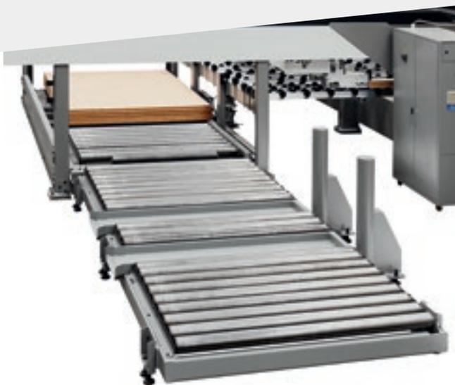
Rodillos previos de doble nivel. Gracias a su reducida altura, los rodillos previos de doble nivel dan la posibilidad de optimizar el espacio, adaptándose perfectamente en las fábricas donde no caben en el suelo dos vías de rodillos una al lado de otra.
