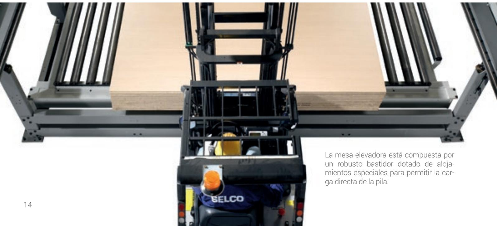
La mesa elevadora está compuesta por un robusto bastidor dotado de alojamientos especiales para permitir la carga directa de la pila.
