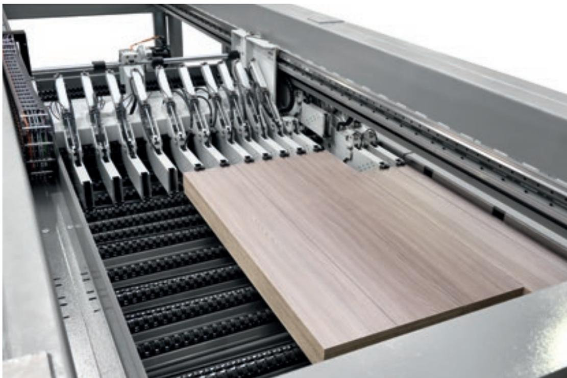
En función del esquema de corte, las dos pinzas libres pueden engancharse, individualmente o ambas, a los dos impulsores.
