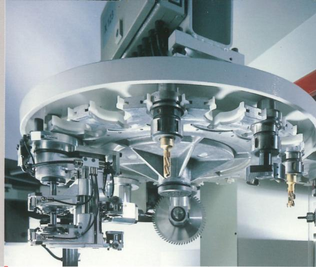
18-fach Werkzeugwechsler für den Einsatz von Adapteraggregaten
