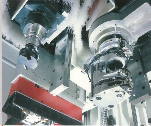
Hauptspindel und Nebenspindel mit Bohraggregat
