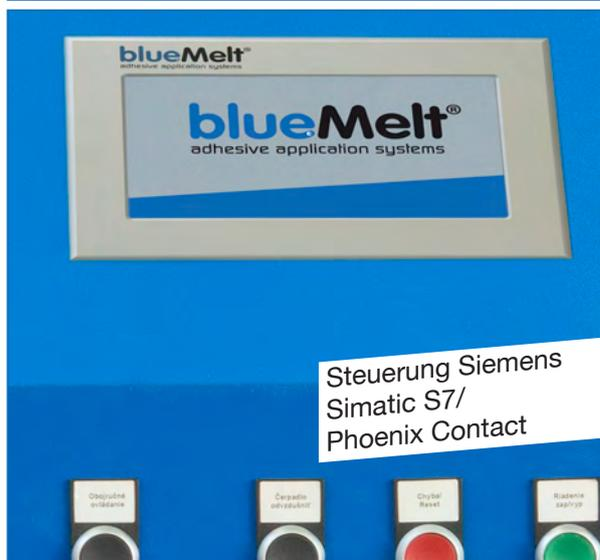
Steuerung Siemens Simatic S7/ Phoenix Contact
